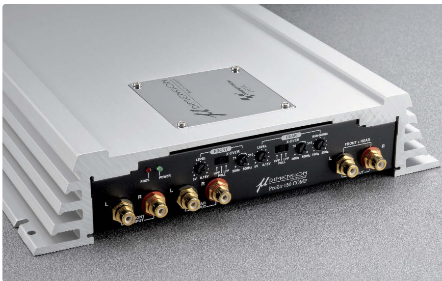
Il pannello in foto mostra sei prese RCA robuste e dorate, quattro ingressi e due uscite. Le regolazioni inoltre sono tutte raggruppate in modo razionale e quindi di facile utilizzo.
