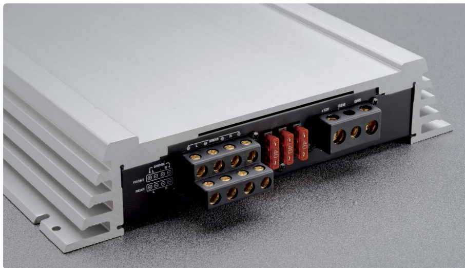
Morsettiere con contatti dorati, da avvitare, dorate per collegare gli altoparlanti e l'alimentazione; la linea a 12 V è protetta da tre fusibili a lama di tipo automobilistico posti in parallelo.
